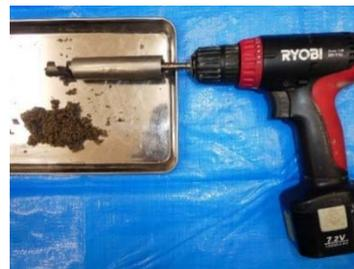
写真8 ハンディドリルでの砂試料の取出し
