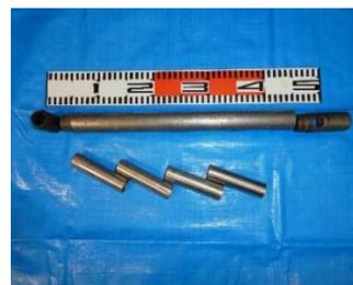
写真 5 試料採取用サンプラー
