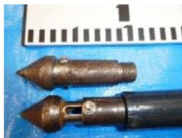
写真 2 水位測定用先端コーン
