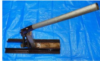
写真7 サンプラーの引揚げ装置（一例）
